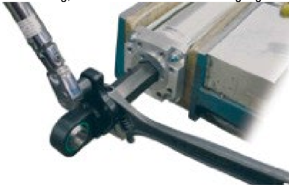
Abbildung 4.4: (SWA abgebildet) Bei Sechskantstangen halten Sie die Schubstange mit einem Schraubenschlüssel an der flachen Seite der Stange fest, wenn Sie Zubehör, Gestänge oder Last am Aktuator befestigen. Verwenden Sie einen Drehmomentschlüssel, um das Ende der Schubstange am Gewindeanschluss des Aktuators festzuziehen. Die Drehmomentwerte in Tabelle 4.2.
